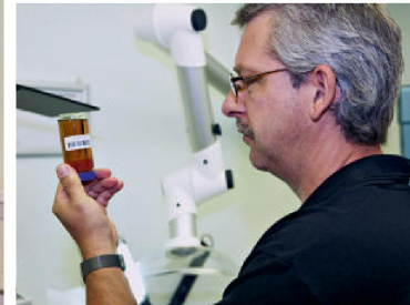
SICHTPRÜFUNG Sind Schwebstoffe vorhanden? Bei frischem Öl eher unwahrscheinlich – keine Vorkommissen
