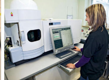
ADDITIVEN AUF DER SPUR Mit einem Atom-Emissions-Spektroskop wird zum Beispiel der Schwefelanteil bestimmt
